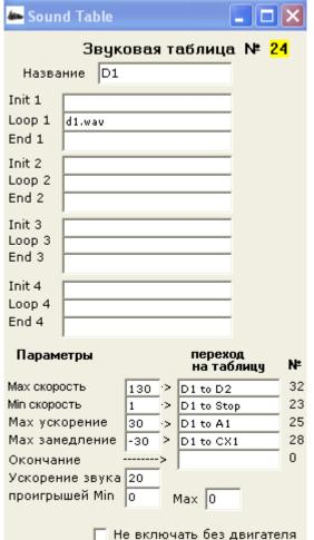
Содержит один трек - Loop1, в нем указан файл d1.wav - циклический кусочек звука дизеля на постоянной скорости. Определены параметры: «Мах. скорость», «Міп. скорость», «Мах. ускорение», «Мах. замедление» с указанием таблицы для перехода и ускорение звука: 20.
